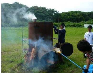
[簡易窯を使った流木の炭焼き実習(飛島)]
